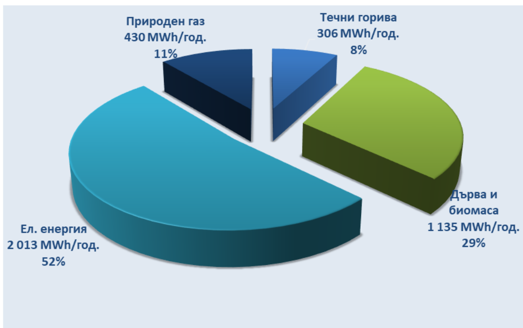
Фиг. СИР-12: Спестена енергия от планираните мерки по видове горива и енергии в MWh/год.
