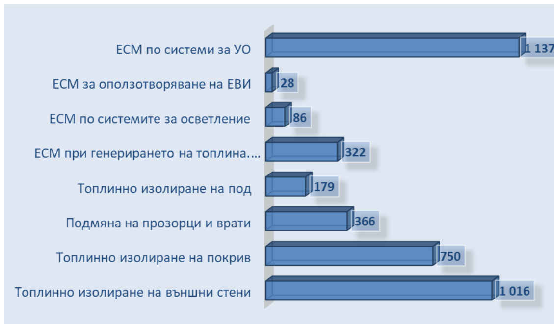
Фиг. СИР-8: Спестени горива и енергии по видове планирани мерки в MWh/год.
